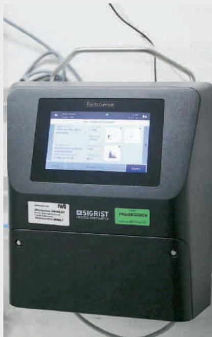
Fig. 7 Online-Durchflusszytometer BactoSense (Sigrist Photometer) zur Messung der Totalzellzahl
