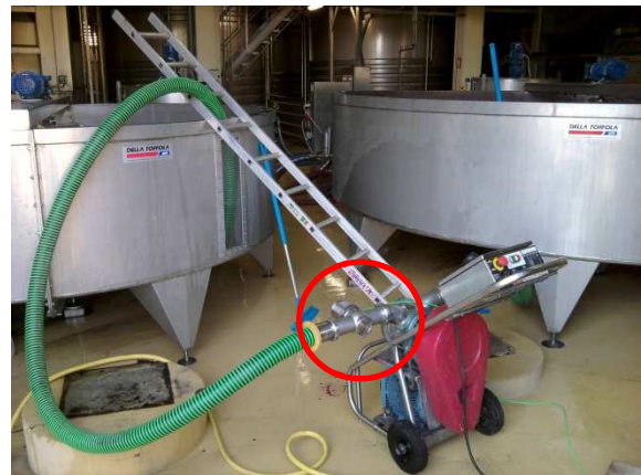
Bild 1: Montage TurbiGuard (eingekreist) auf Pumpenwagen
