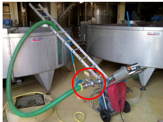
Illustration 1: TurbiGuard (encerclé) monté sur chariot de pompage
